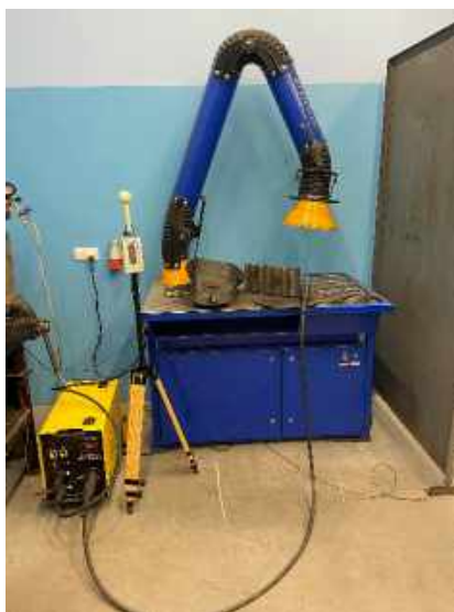
Rys. 1. Stanowisko pomiarowe spawalnicze metodą MAG
