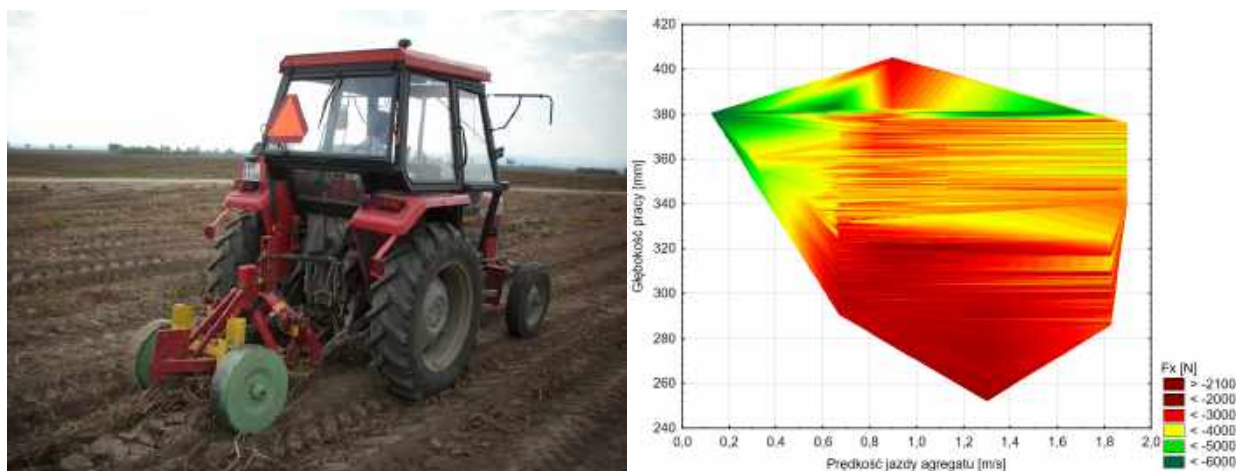
Rys. 2. Widok sytemu pomiarowego w czasie badań oraz przykładowa charakterystyka siły w łączniku górnym TUZ będąca składową oporu roboczego w relacji z głębokością pracy i prędkością jazdy
