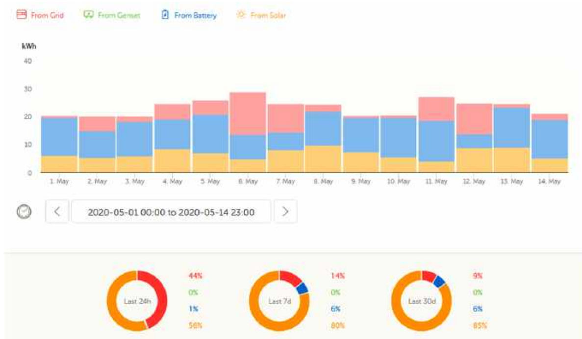
Rys. 1. Graficzne zestawienie informacji o źródłach pochodzenia energii elektrycznej zużytej w budynku
