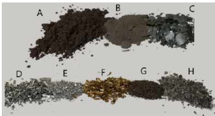
Rys. 1. Potencjalne surowce do konstrukcji kompozytów A, B – pyły złomowiskowe, C – zgorzelina walcownicza, D, E – wióry aluminiowe, F – wióry mosiężne, G, włókna miedziane, H – odpady rudy cyny.
