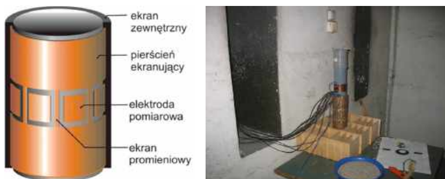
Rysunek 2: Schemat zastosowanego czujnika ECT (po lewej) oraz fotografia stanowiska badawczego (po prawej)
