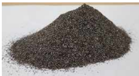
Rys. 3. Rozdrobniony oplot miedziany
