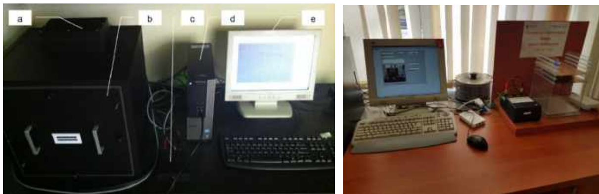
Rys. 1. Stanowisko badawcze: a) – do badania ultrasłabej emisji fotonowej (a – element światłoczuły (fotopowielacz R 1538-13), b – komora światłoszczelna, c – interfejs urządzenia, d – jednostka centralna (komputer), e – interfejs programu BioLumisyna), b – do oddziaływania stałym polem elektrycznym
