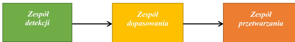
Rys. 3. Blokowy schemat polowego miernika sygnałów elektromagnetycznych
