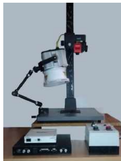
Fot. 1. Stanowisko do badań nieniszczących z zastosowaniem aktywnej termografii przy użyciu jednej lampy halogenowej o mocy 2,5 kW
