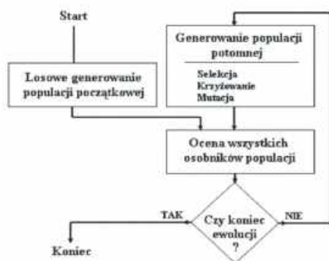
Rys. 2. Schemat blokowy algorytmu genetycznego
