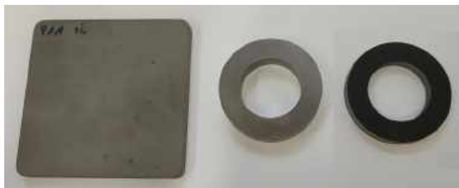
Rys. 2. Wstępna próbka kompozytu – zendra - PVC
