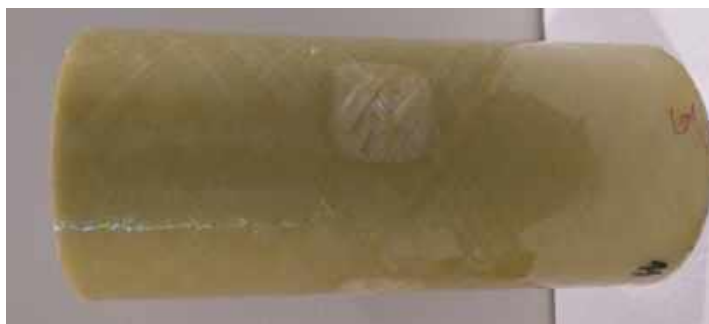
Rys. 1. fragment uszkodzonej rury kompozytowej
