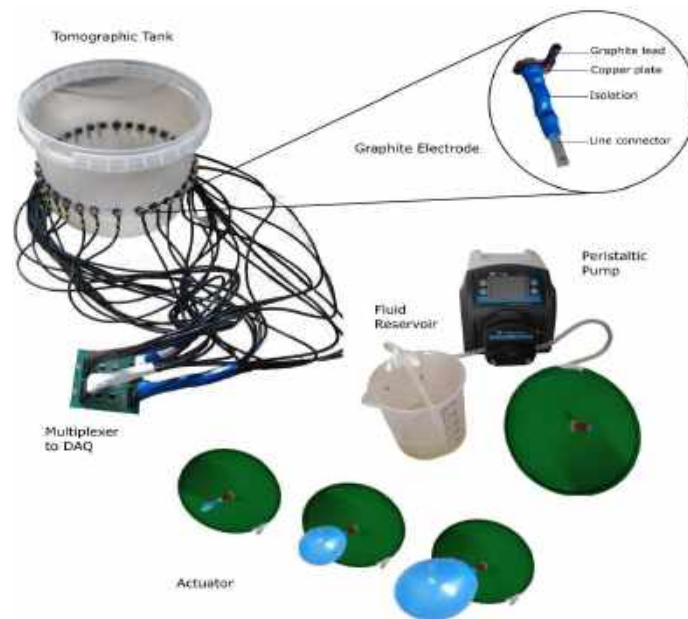
Fig. 2. EIT tank system for Dynamic Phantom
