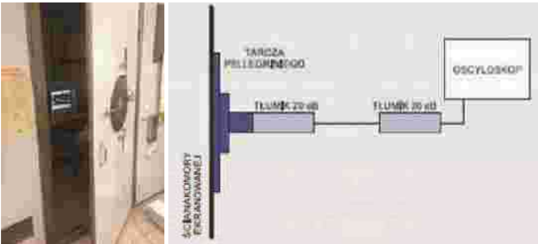
Rys. 1. Uproszczony schemat układu kalibracji generatora ESD
