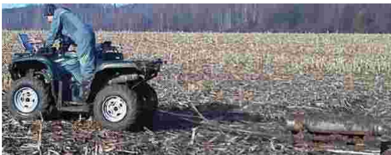
Rysunek 1. Pomiar przewodności elektromagnetycznej sondą EM38
