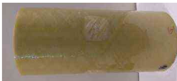
Rys. 1. fragment uszkodzonej rury kompozytowej
