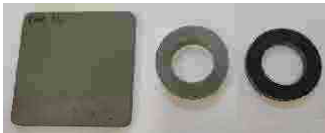
Rys. 2. Wstępna próbka kompozytu – zendra - PVC
