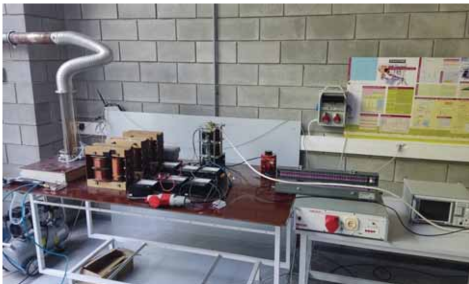
Rys. 1. Stanowisko pomiarowe z reaktorem trójfazowym Glidarc
