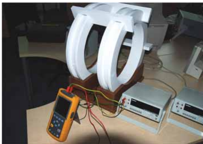
Rys. 1. Stanowisko do badań materiałów biologicznych poddawanych ekspozycji w przemiennym polu magnetycznym o częstotliwości 50 Hz o regulowanym natężeniu
