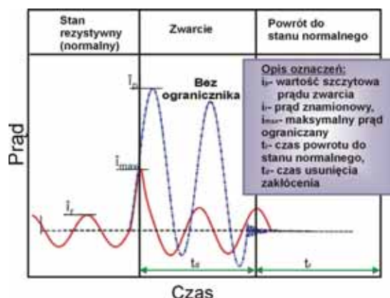
Rys. 1. Koncepcja pracy nadprzewodnikowego ogranicznika prądu [5],[6]
