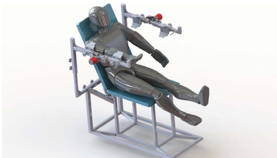
Rys. 1. Projekt robota rehabilitacyjnego [5]
