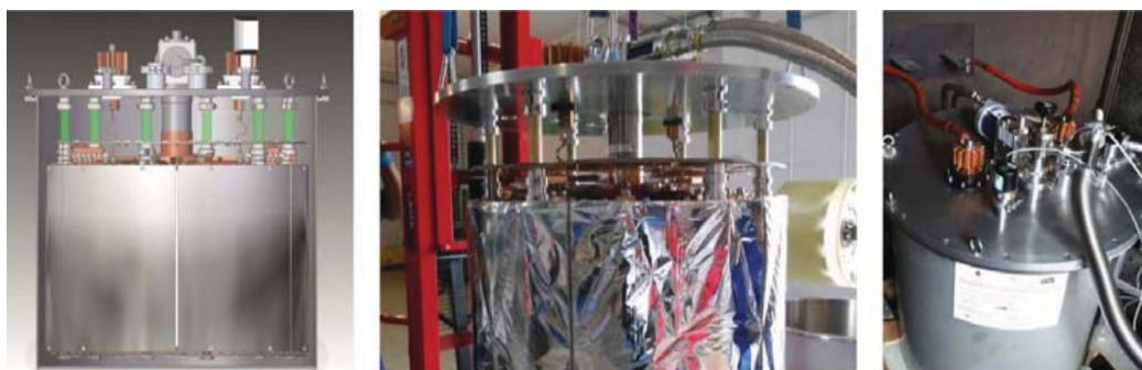
Rys. 1. Prototyp ogranicznika rezystancyjnego chłodzonego kontaktowo (konsorcjum: Instytut Elektrotechniki, Uniwersytet Zielonogórski, Frako-Term sp. z o.o.) [11]
