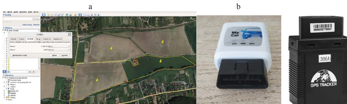
Rys. 1. Poligon doświadczalny (a) oraz urządzenia transmitujące sygnał z systemu informatycznego ciągnika (b)
