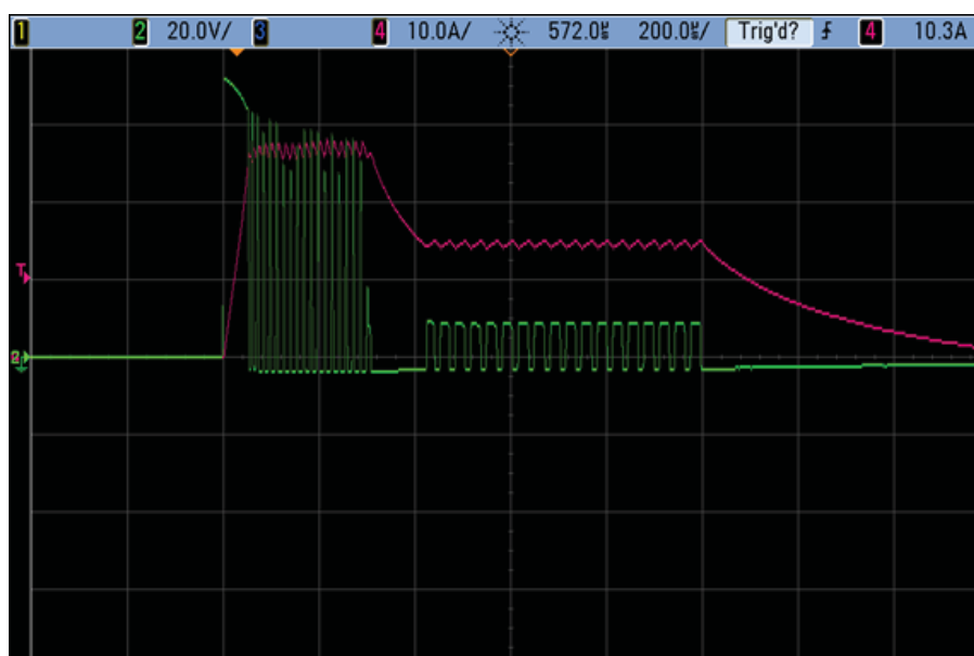
Rys. 1. Typowe przebiegi zmian napięcia i prądu w układzie sterowania wtryskiwaczem
