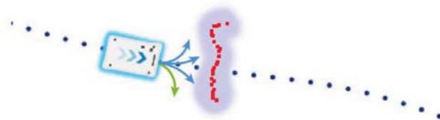
Rys. 5. Omijanie przeszkody poprzez system ścieżek lokalnych
