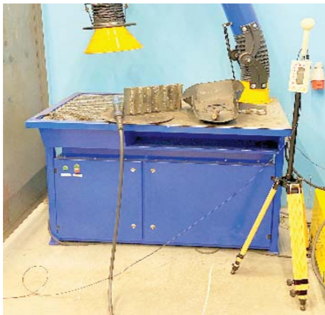
Rys. 1. Stanowisko spawalnicze wraz z miernikiem ESM-100
