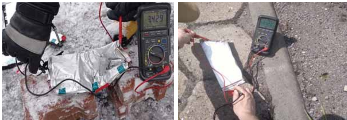
Rys. 1. Rozkład spoczynkowego napięcia w mechanicznie uszkodzonych ogniwach litowo-jonowych
