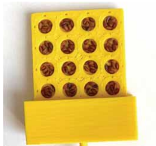
Rys. 2. Matryca używana do napromieniania nasion pieprzycy siewnej
