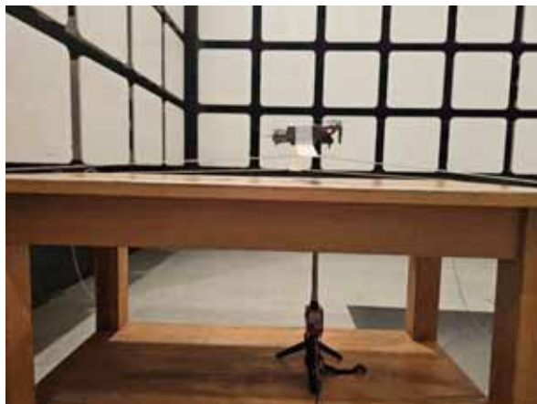
Rys. 1. BSP na stanowisku badawczym w bezodbiłowej komorze pomiarowej
