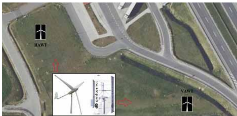
Rys. 1. Miejsca instalacji elektrowni wiatrowych: Falcon FNSW 3kW (HAWT) i Ecorote 2800 (VAWT) na terenie zielonym MOP Wronczyn
