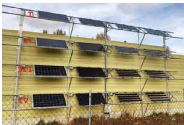
Rys. 2. Badane panele fotowoltaiczne (rzędy od lewej: monofacjalny 300 W, referencyjny bifacjalny 300 W, bifacjalny z rozstawem 40 mm 200 W, bifacjalny z rozstawem 80 mm 200 W)
