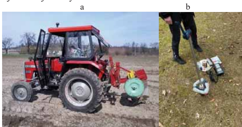
Rys. 1. Aparatura badawcza; a) tensometryczny system do pomiarów eksploatacyjnych, b) płyta obciążana dynamicznie ZFG 3.1
