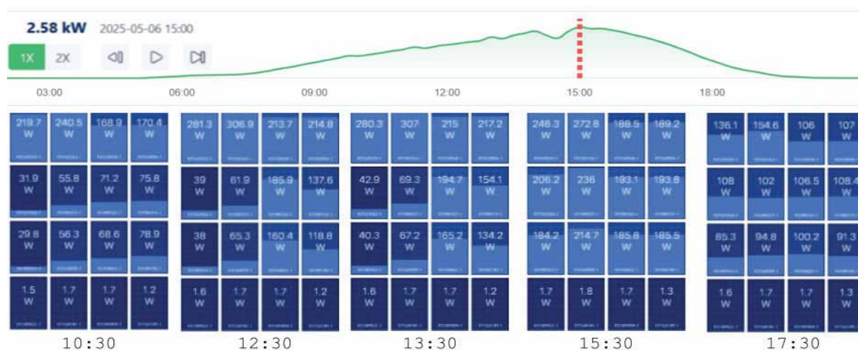
Rys. 3. Generacji energii elektrycznej całej instalacji oraz poszczególnych paneli
