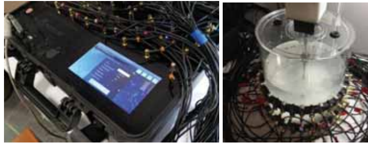
Fig. 1. EIT tomograph with HMI interface and industrial reactor
