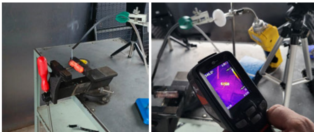
Rys. 1. Rejestracja zmian temperatury oraz emisji gazów podczas próby uszkodzenia mechanicznego ogniwa litowo-jonowego
