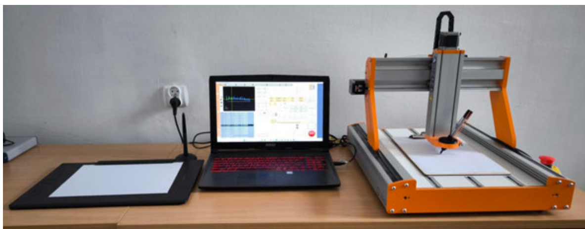
Rys. 2. Stanowisko do rejestracji i odtwarzania pisma odręcznego za pomocą urządzenia CNC
