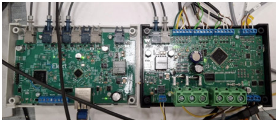
Rys. 2. Autorska płytką sterująca układu napędowo-pomiarowego - rysunek z pracy inżynierskiej [opracowanie własne]
