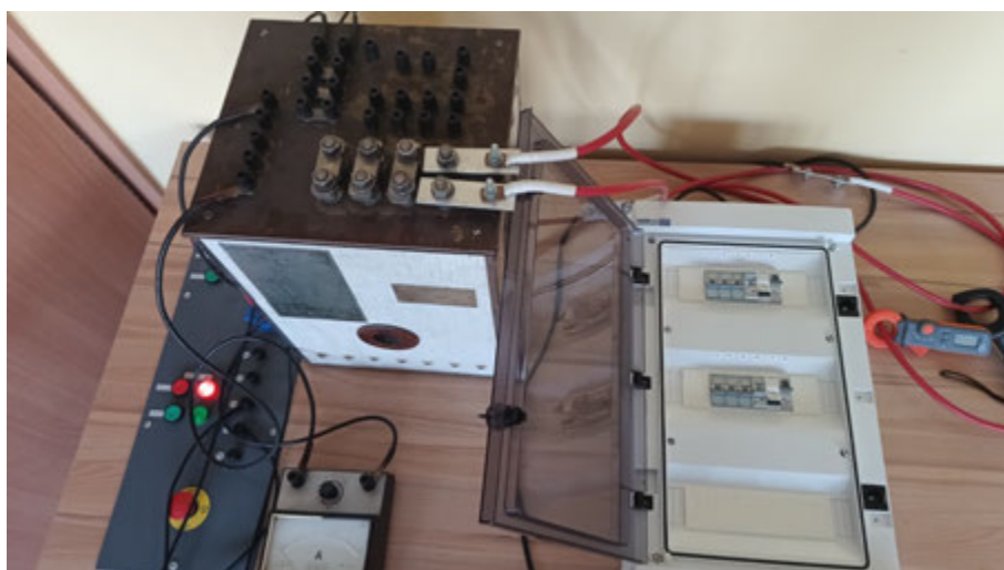
Rys. 1. Widok stanowiska do badania wyłączników nadprądowych
